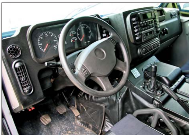
Унапређени предњи панел „волка“ приказаног у пролеће 2011. године на изложби у Броњицама, са измењеном инструментним таблом и борд-компјутером на средини панела
