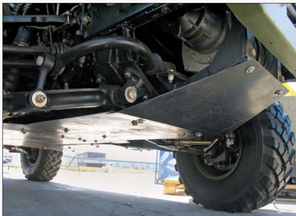
Доња страна „волка“ јесте заштићена масивним челичним плочама, али први, односно други сљедећи противминске заштите по стандарду STANAG 4569 није остварен њеним уобичајеним „V“ обликом, већ композицијом заштићеним „сендвичем“ у подову возила
