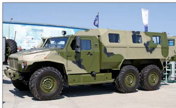
„Вук“ у конфигурацији 6x6 – ВПК-39273, на продуженој шасији основног модела
