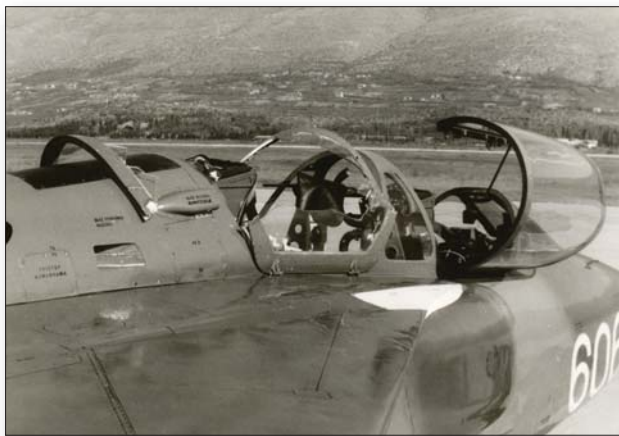
Током полетања авионом ИНЈ-22М 29. јануара 1986, на висини од 20 до 30 метара, капетану прве класе Милошу Стилићу, пилоту 353. иае, отворила се друга кабина. Пилот је ушао у школски круг и нормално слетео. Поклопац кабине улубио је лим на хрбају изнад уписника. (353. ескадрила)
